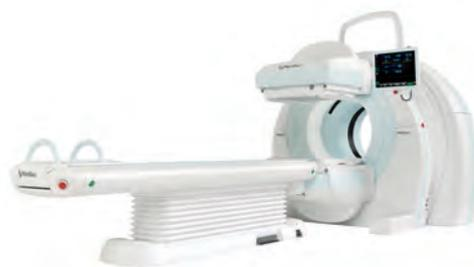
AnyScan SC liefert exzellente technische Werte. Es besteht aus einem modernen, hochauflösenden 16-Zeilen-CT mit einer Rotationsgeschwindigkeit von 0,5 s bei 360-Grad-Rotation und einer Doppelkopf-Rechteck-Gammakamera. Der CT kann voll für die radiologische Diagnostik eingesetzt werden. Das System besitzt ein innovatives Gantrykonzept, das jederzeit auf ein SPECT/CT/PET-System (AnyScan) aufgerüstet werden kann.
