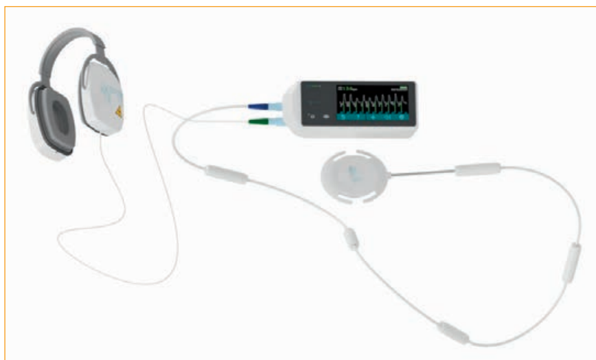
Sensorbox mit Ultraschallkopf und Kopfhörer: Der Herzschlag des Fötus wird auf dem Display angezeigt. Der Kopfhörer dient der Lokalisation des Ultraschallkopfs.
