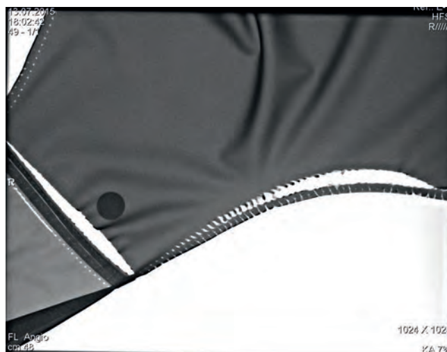
Nahtisse wie hier im Schulter- und Halsbereich einer Schürze können bei Tastprüfungen leicht übersehen werden. Deshalb empfiehlt der TÜV Süd eine jährliche Prüfung mit Röntgenstrahlen.
