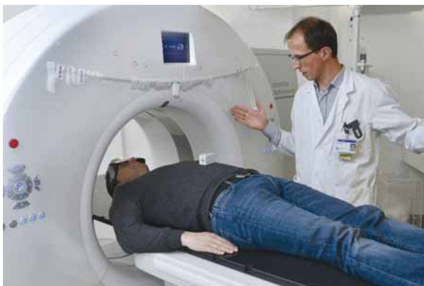
Das UniversitätsSpital nutzt die Epson-Datenbrille BT-100, um die Atmung der Patienten während der CT-Untersuchung zu verbessern. Als Atemsensor dient eine Sonde (weißes Kästchen) auf dem Bauch des Patienten.
